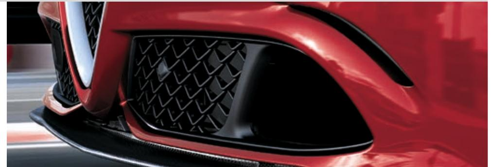
Die neue Giulia Quadrifoglio ist als einziges Fahrzeug ihrer Klasse mit einem Active Aero Splitter ausgestattet. Dabei handelt es sich um einen aktiven Frontspoiler aus Kohlefaser, der bei hoher Geschwindigkeit und auf Geraden geschlossen bleibt. Der Splitter öffnet sich automatisch beim Bremsen und in Kurven. Dies garantiert maximale
